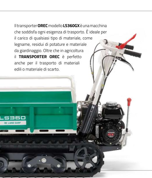
Il perfetto bilanciamento anteriore/posteriore permette una migliore distribuzione dei carichi ed una ottimale aderenza al terreno. I freni di stazionamento, annessi al cambio, assicurano una notevole stabilità e sicurezza: si attivano, infatti, automaticamente al rilascio dei comandi. Lasciando la macchina in posizione neutra, anche in forte pendenza, questa resta perfettamente bloccata.
