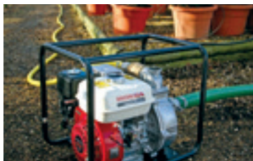
La pressione fino a 5 bar rende i modelli della gamma WH adatti allo spostamento dell'acqua per lunghe distanze.
